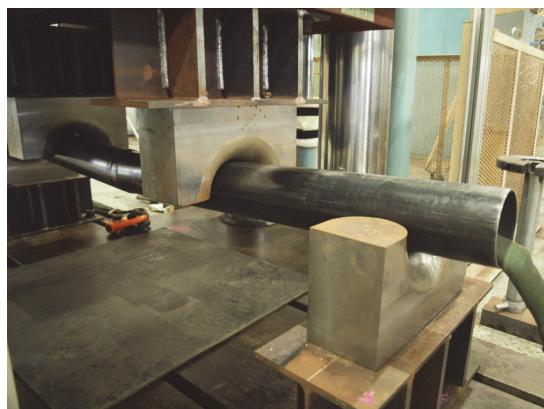
写真-2 曲げ試験実施状況
