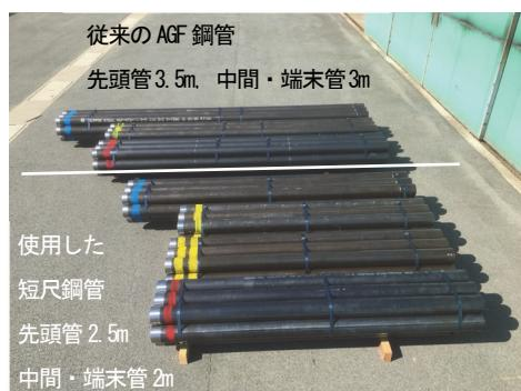
写真-7 使用した短尺の軽量鋼管 (白線より下)
